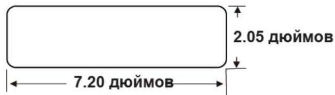
Вставьте монтажную втулку в приборную панель. Затем отогните выступы на монтажной втулке отверткой, чтобы добиться закрепления монтажной втулки.
