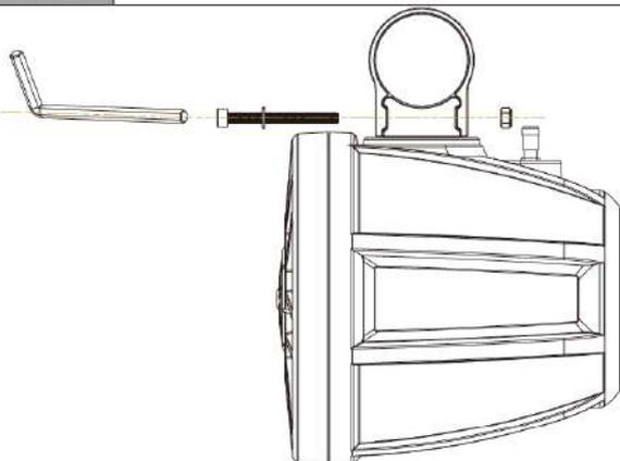
Прикрепите алюминиевые ленты к металлическому основанию с помощью пары винтов М6 х 60 мм, плоских шайб М6 и контргаек М6, как показано на рисунке. Контргайку следует установить в шестигранную выемку на одном конце каждой ленты. Затяните вручную, чтобы обеспечить достаточную свободу вращения динамика waketower вокруг стержня клетки.
